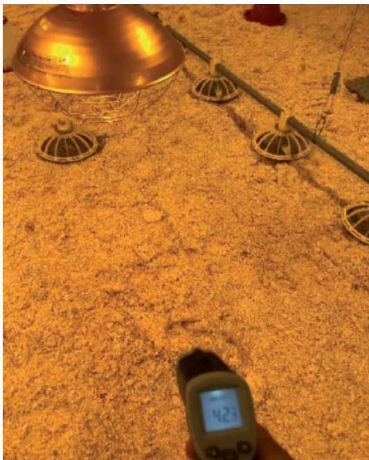
Obr.č.9. Meranie teploty pod elektrickou kvočkou
